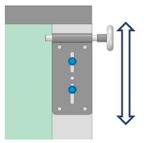
ADJUST THE TOP BRACKET WITH INSIDE SCREWS
