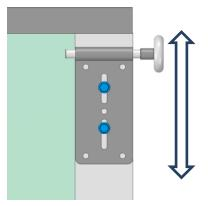
ADJUST THE TOP BRACKET WITH INSIDE SCREWS
